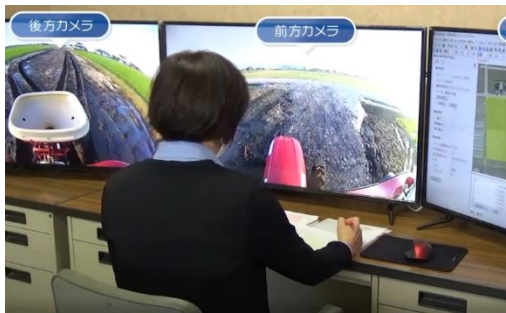
複数ほ場を自律的に移動、 作業する農機制御システム
