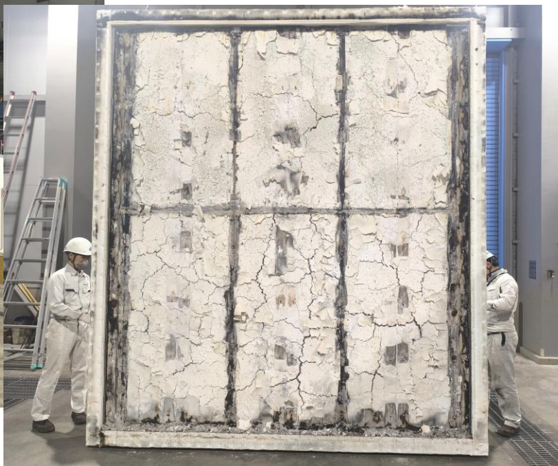
脱炉後木毛セメント板1枚目
