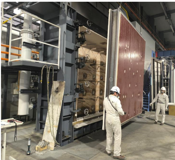
大臣認定試験炉と 試験体脱炉時の様子
